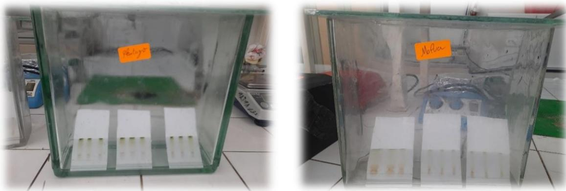
**Figure 14 :** Analyse des extraits méhanoliques par chromatographie sur couche mince
