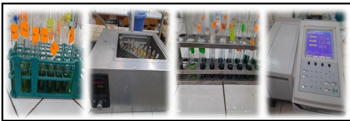
**Figure 15 :** les étapes du test du pouvoir réducteur du fer par la méthode de FRAP
